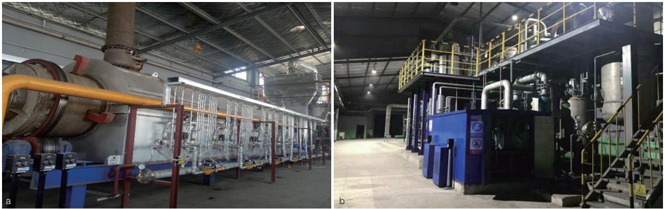
图3 中国自主研发的年产万吨秸秆生物质炭生产集成系统 (a) 连续热裂解炭化转窑系统；(b) 热解产物气、液和固三相分离纯化系统
